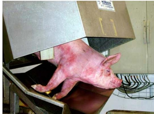
ภาพที่ 30 การทำให้สลบด้วยไฟฟ้าโดยผ่านเครื่องระบบอัตโนมัติ
